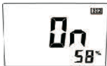
Fig. 35: Enabling RS232 mode
