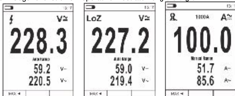
Fig. 6 Descrizione misura tensione e corrente AC+DC
